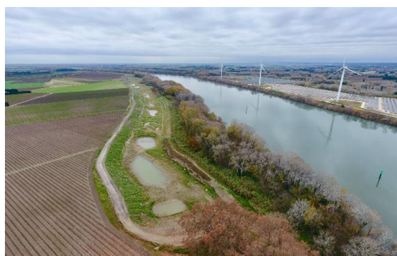
Photo 3. Démontage des digues et reconstruction en recul du fleuve et création de zones humides (© Symadrem)
