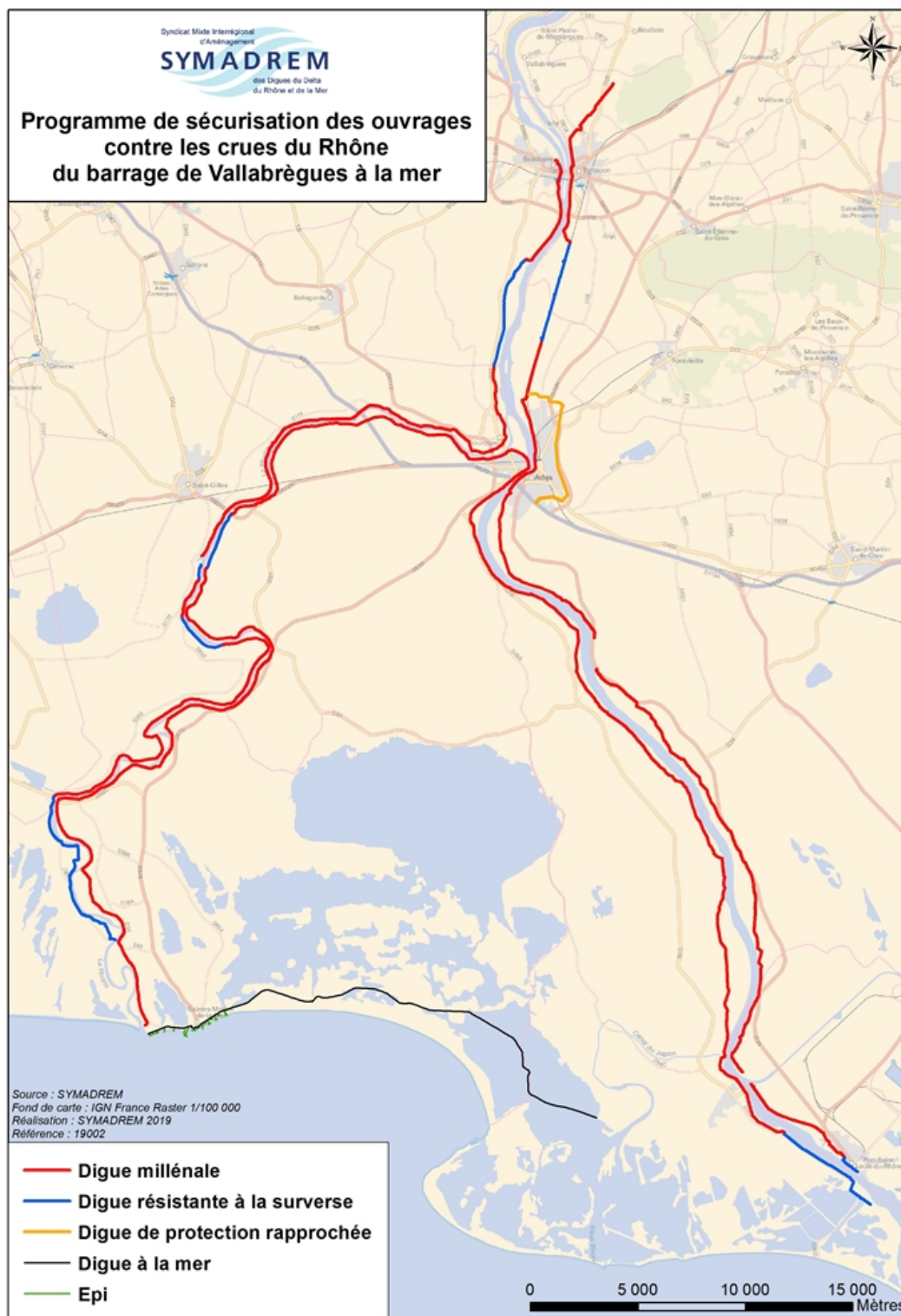
Figure 6 : Programme de sécurisation des ouvrages de protection contre les crues du Rhône du Barrage de Vallabrègues à la Mer
