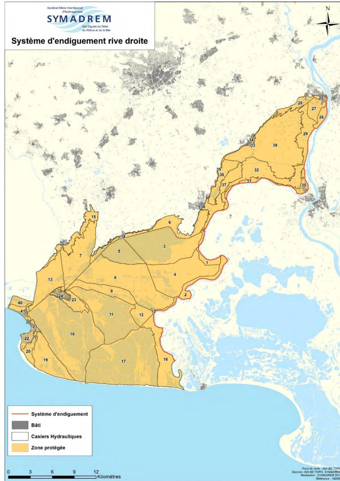
Figure 6. Découpage de la zone protégée rive droite en 41 sous-zones protégées
