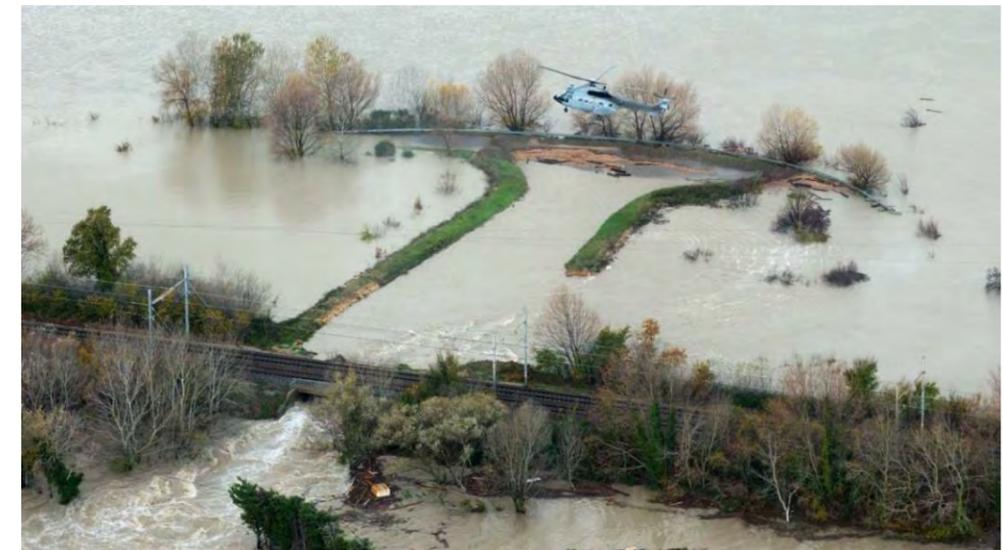
**Photo 19.** Décembre 2003 - rupture des digues de protection des trémies SNCF à l'origine de l'inondation en rive gauche du Rhône (© SDIS13)
