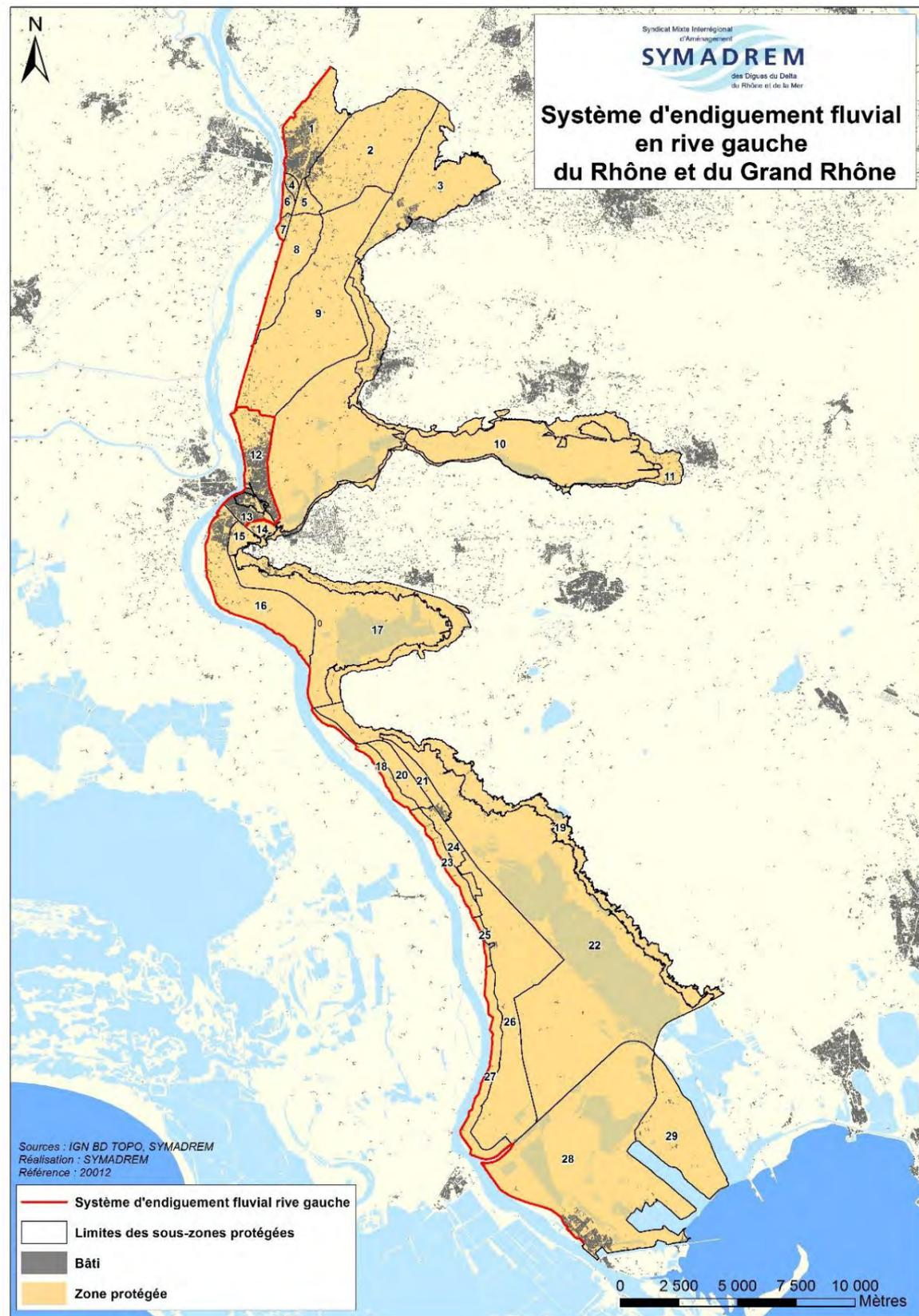
Figure 5. Découpage de la zone protégée rive gauche en 29 sous-zones protégées
