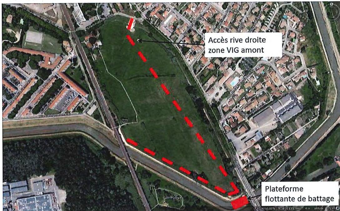
L'accès sur la partie amont de la voie ferrée sera plus délicat, le gabarit des machines utilisées pour ce tronçon devra être vérifié quant à la taille de l'arche du pont SNCF (h<4m).
