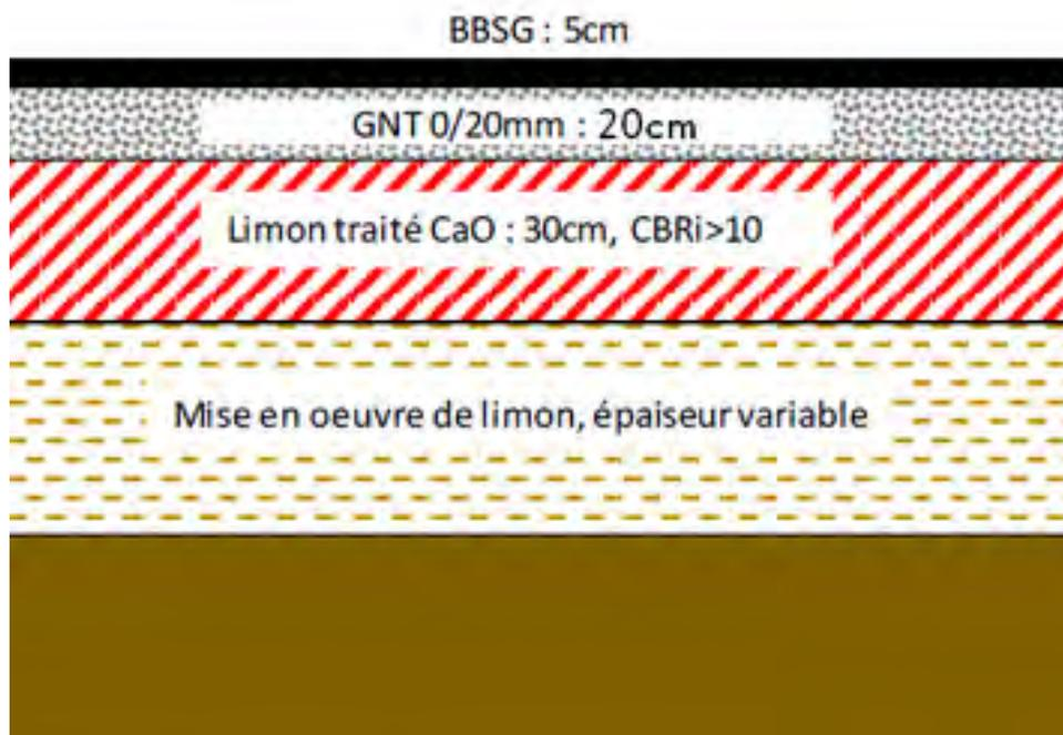
Figure 1 : Réalisation d'un enrobé
