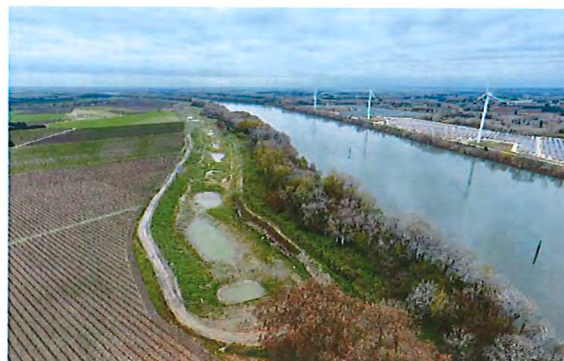
Photo 3. Démontage des digues d'origine, reconstruction en recul et création de zones humides (© Symadrem)
