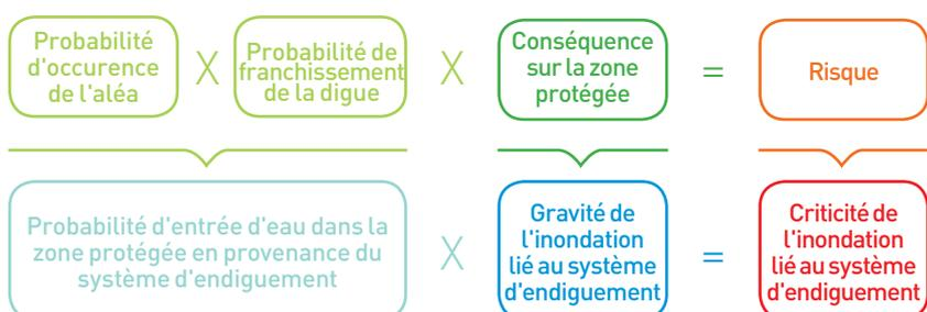
La probabilité d'entrée d'eau dans la zone protégée est basée sur cinq modèles, construits à partir d'investigations exhaustives menées dans le cadre d'un diagnostic approfondi : un modèle hydraulique et un modèle morpho-dynamique pour la détermination de probabilité d'occurrence de l'aléa et trois modèles respectivement géométrique, géotechnique et fonctionnel pour l'évaluation de la probabilité de résistance et de franchissement de la digue.
