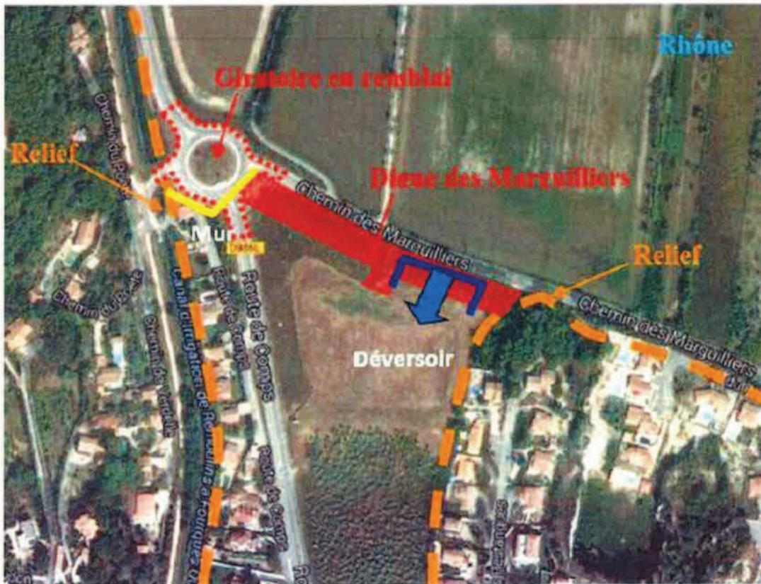
La délimitation de la zone protégée par le système d'endiguement (extraction BDAI IGN 50 m selon la cote du déversoir 14 m NGF) est représentée sur la figure ci-dessous :
