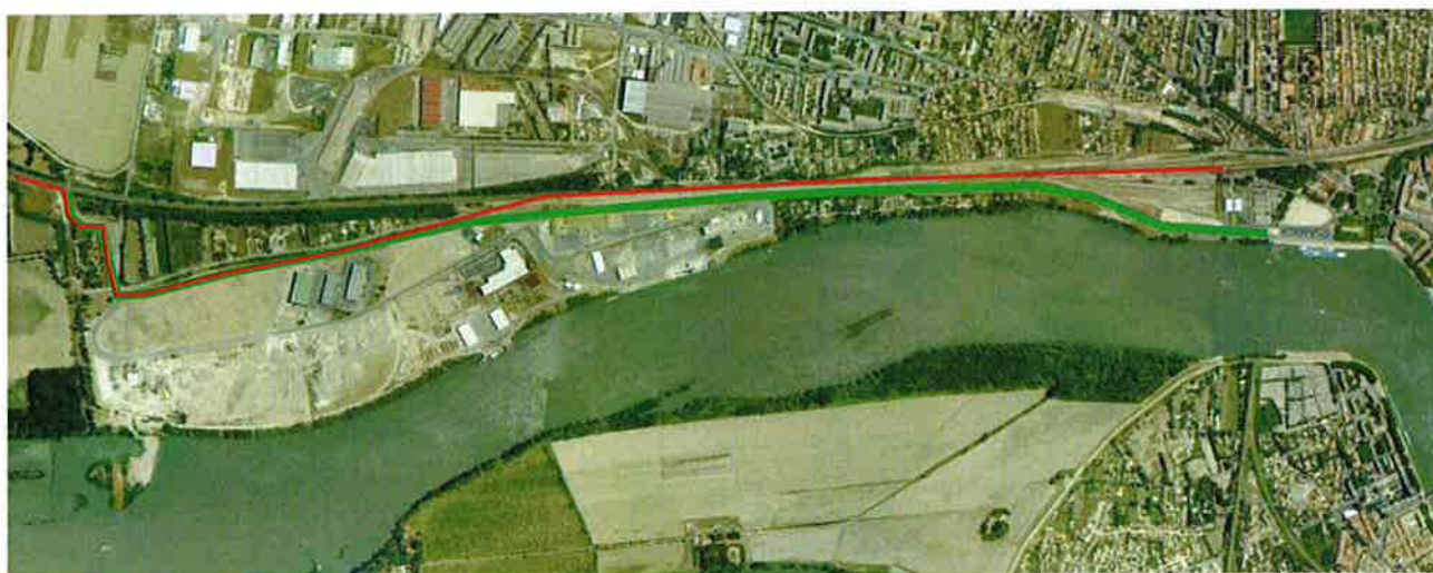
Figure 2 : Lignes de protection en amont rive gauche des quais d'Arles (protection actuelle en rouge, protection objet des travaux en vert)
