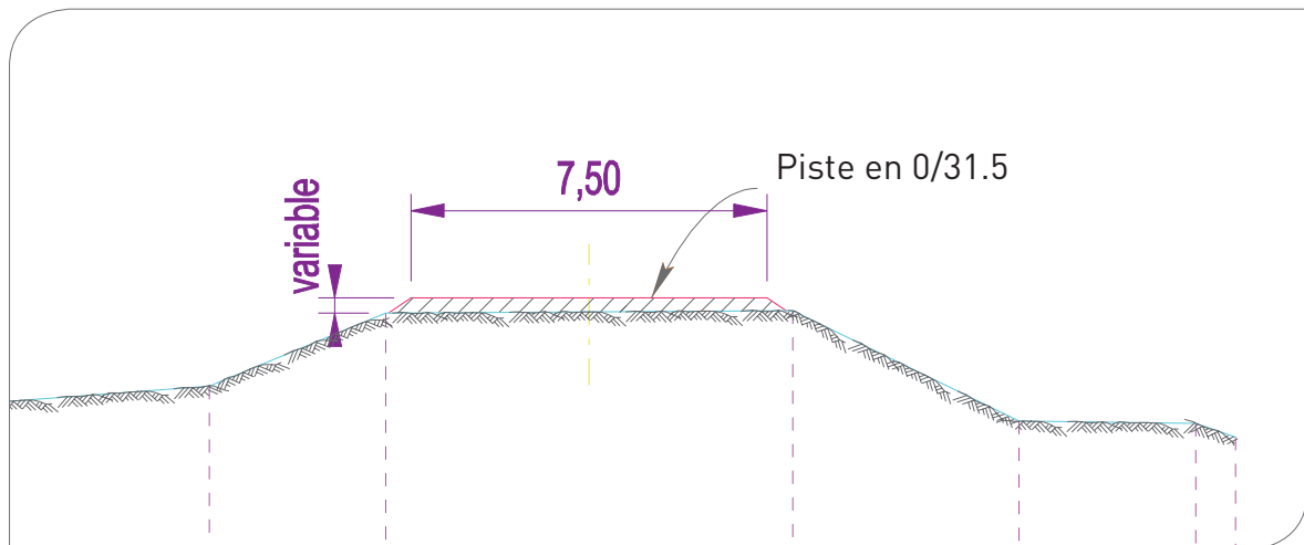
Schéma de principe de rehausse de la digue de Barriol (source ISL [R96a])
