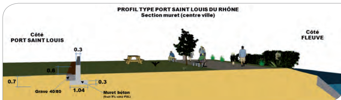
Parapet résistant à la surverse (source SOGREAH [R88])
