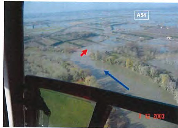
Figure 1. Exemple d'inondation du val protégé provoquée par une rupture par brèche (Brèche du Mas d'Argence en rive droite du Petit Rhône lors de la crue de décembre 2003). L'autoroute A54 a été fermée pendant 15 jours.
